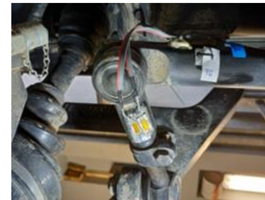
Tenzometrické měření mechanického napětí v pojezdu speciálního vozidla
