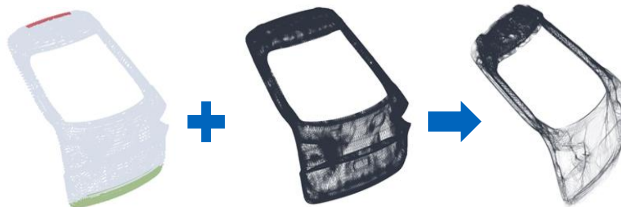
Pevnostní výpočtový model pevnosti zadních dveří osobního automobilu
