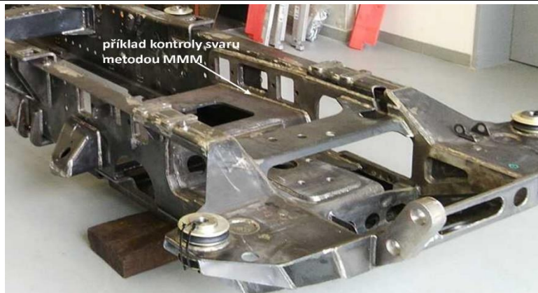
Kontrola svařeného rámu speciálního vozidla metodou MMM
