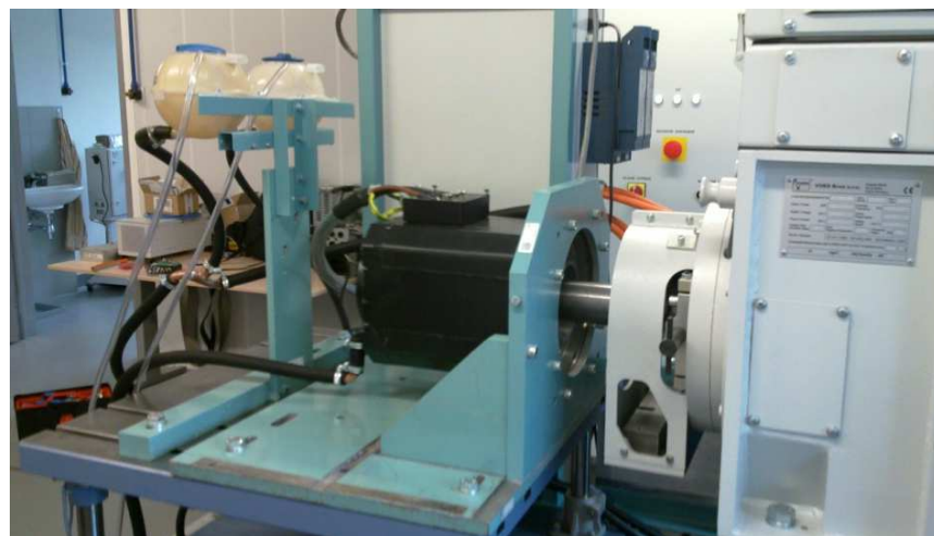
„Ladění“ elektrického pohonu E-Rapidu na zkušebním pracovišti
