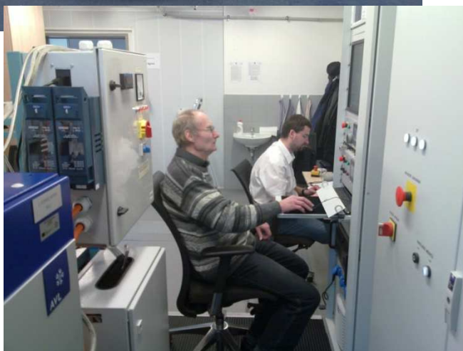
„Ladění“ elektrického pohonu E-Rapidu na zkušebním pracovišti
