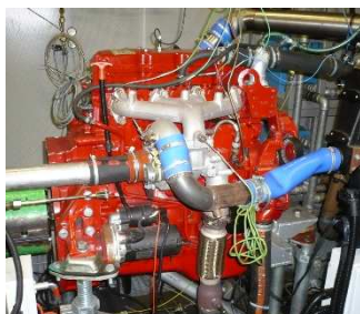
Plynný vznětový (tzv. dvojpaliivový) motor – původní vozidlový vznětový přeplňovaný motor CUMMINS ISBE-150 (EURO 4 – 4BTA)
