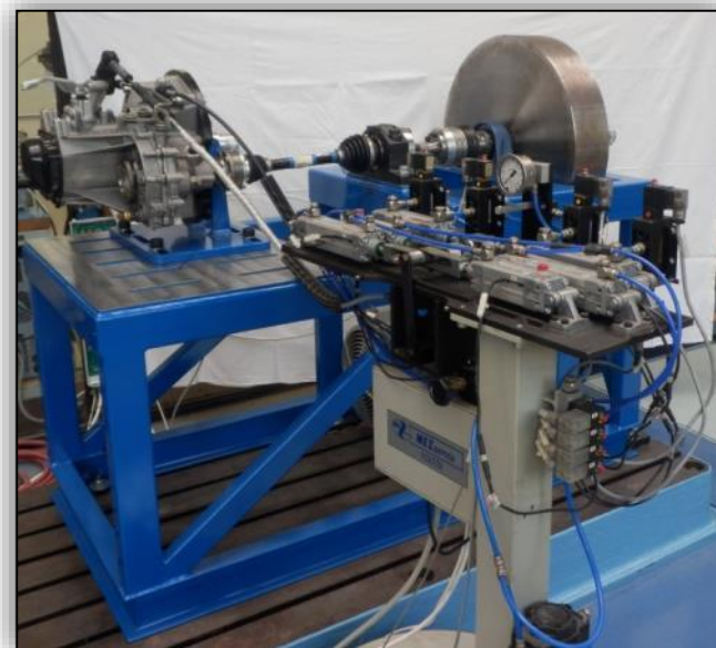
Experimentální testovací stand pro nekonvenční systémy řazení (ČVUT v Praze).
