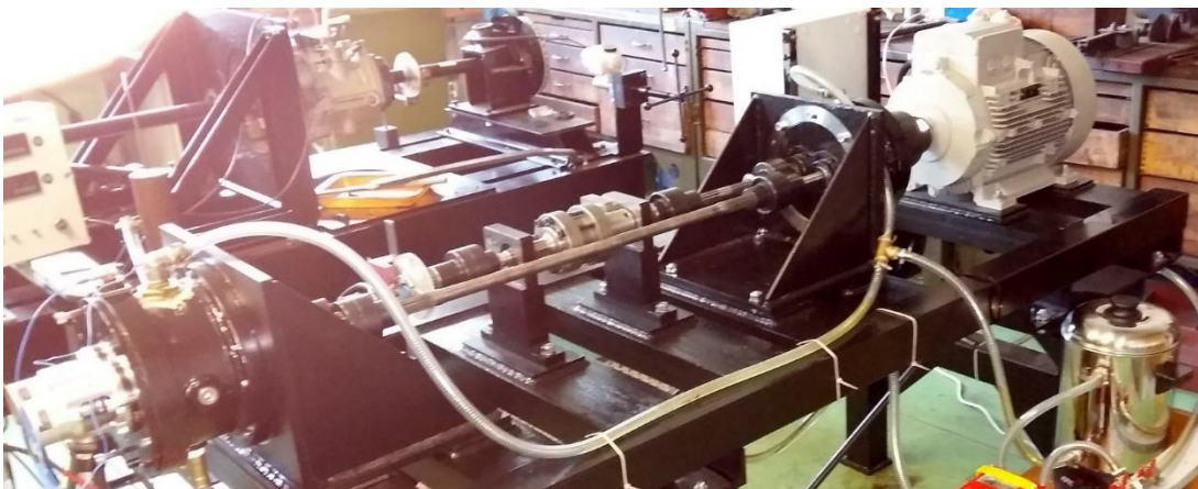
Stand na měření hluku, vibrací a chyby převodu (VŠB- TU Ostrava)
