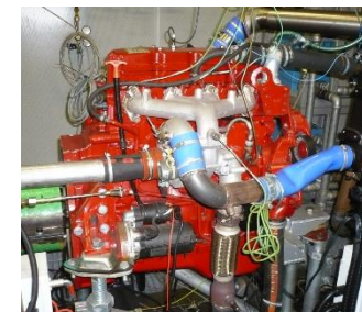
Plynový vznětový (tzv. dvojpalivový) motor – původní vozidlový vznětový přeplňovaný motor CUMMINS ISBE-150 (EURO 4 – 4BTA)
