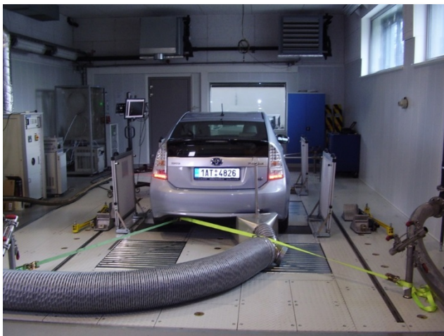
Zkoušení vozidla na válcové brzdě VTP Roztoky
