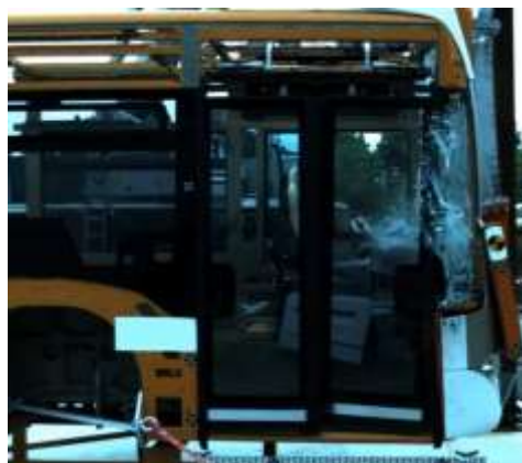
Fyzický experiment nárazu kyvadlem EHK 29 - autobus
