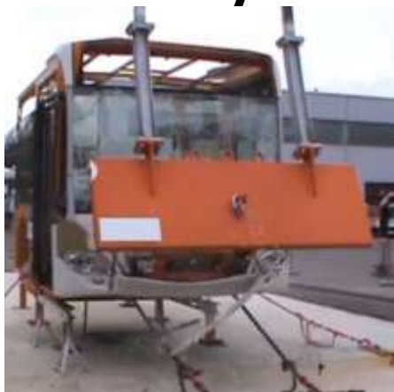
Fyzický experiment nárazu kyvadlem EHK 29 - autobus
