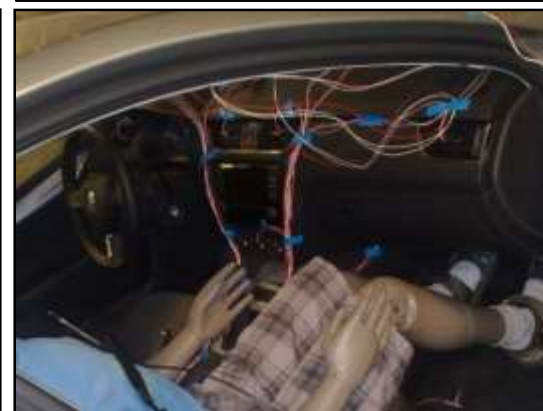
Čidla Pt100 na palubní desce
