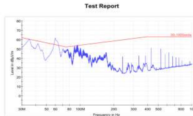
Obr3.: naměřené úrovně elmag. rušení vyzařované běžící jednotkou
