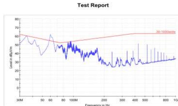
Obr3.: naměřené úrovně elmag. rušení vyzařované běžící jednotkou
