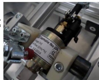
Prototyp čerpadla paliva, hořáku a spalovací komory
