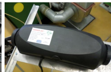
Prototyp čerpadla paliva, hořáku a spalovací komory
