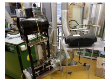
Testovací stanoviště BRANO pro zkoušky hořáku a spalovací komory
