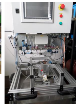
Testovací stanoviště BRANO pro zkoušky čerpadla paliva
