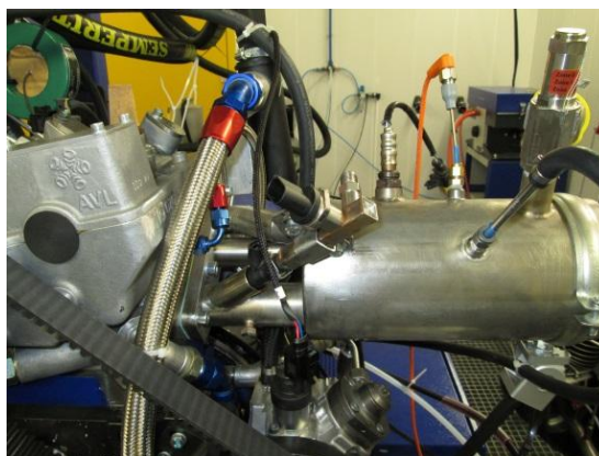
provedení úprav sacího potrubí
