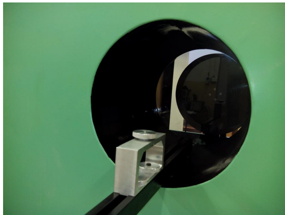
Detail posuvného lože pro instalaci kamery
